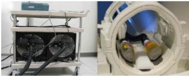
Figure 9: Photographie à gauche des deux subwoofers modifiés pour délivrer des ondes de pression dans les actionneurs pneumatiques installées à droite dans une antenne tête.
